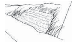
sistema de gaviones en hileras estabilizando talud.
