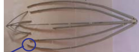
4 Juntar los extremos de los tubos y colocar cuadernas en la quilla.
