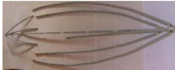
3 Insertar el traslape de las rodas en la quilla y asegurar con el botón.
