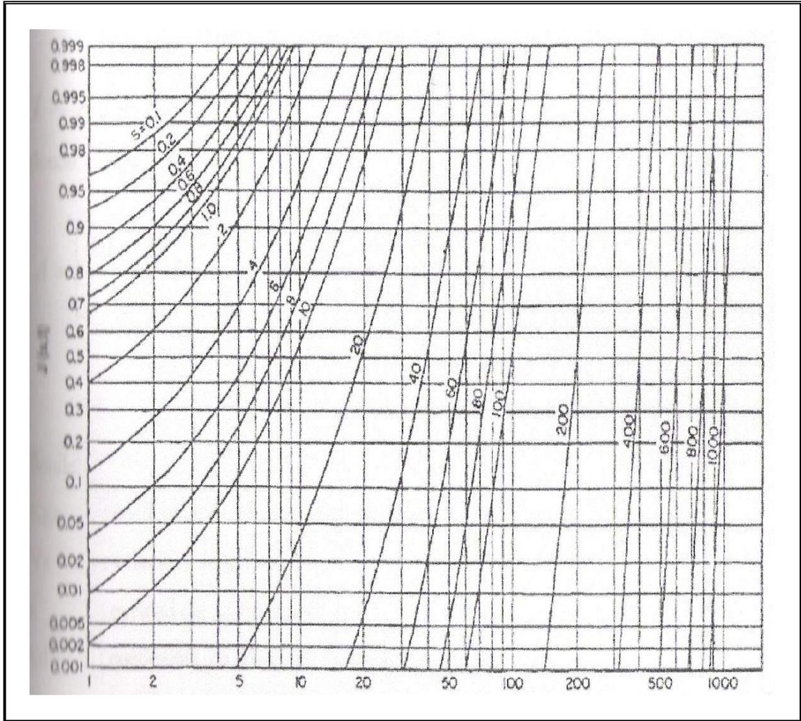
**Figura 9.-** Velocidad de Inundación, Platos Perforados.
