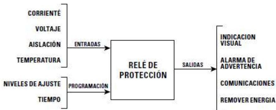
Figura D-1: Diagrama de entradas y salidas de un relé.
