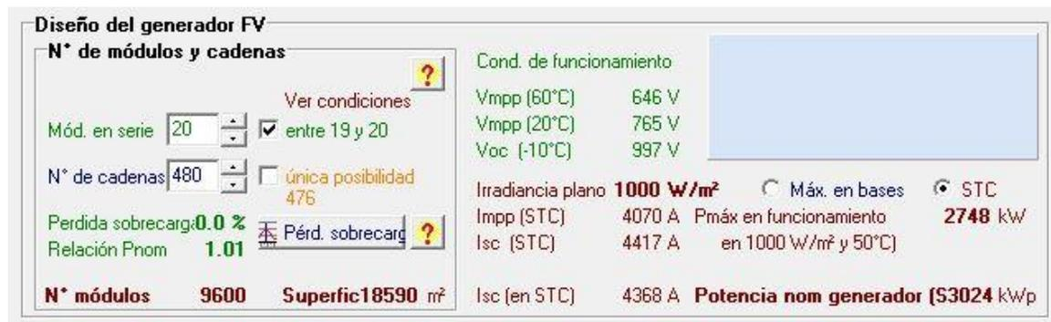
Figura 2-5. Diseño generador FV editado (fuente: PVsyst)
