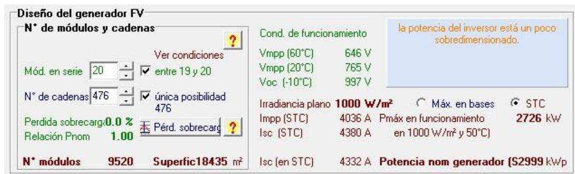
Figura 2-4. Diseño Generador Fotovoltaico (fuente: PVsyst)
