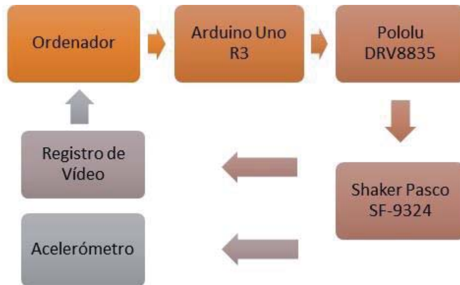
Figura 1-1: Esquema representativo del orden de procesos dentro del sistema programable de excitación de sensores de aceleración, involucrando a cada uno de sus componentes.
