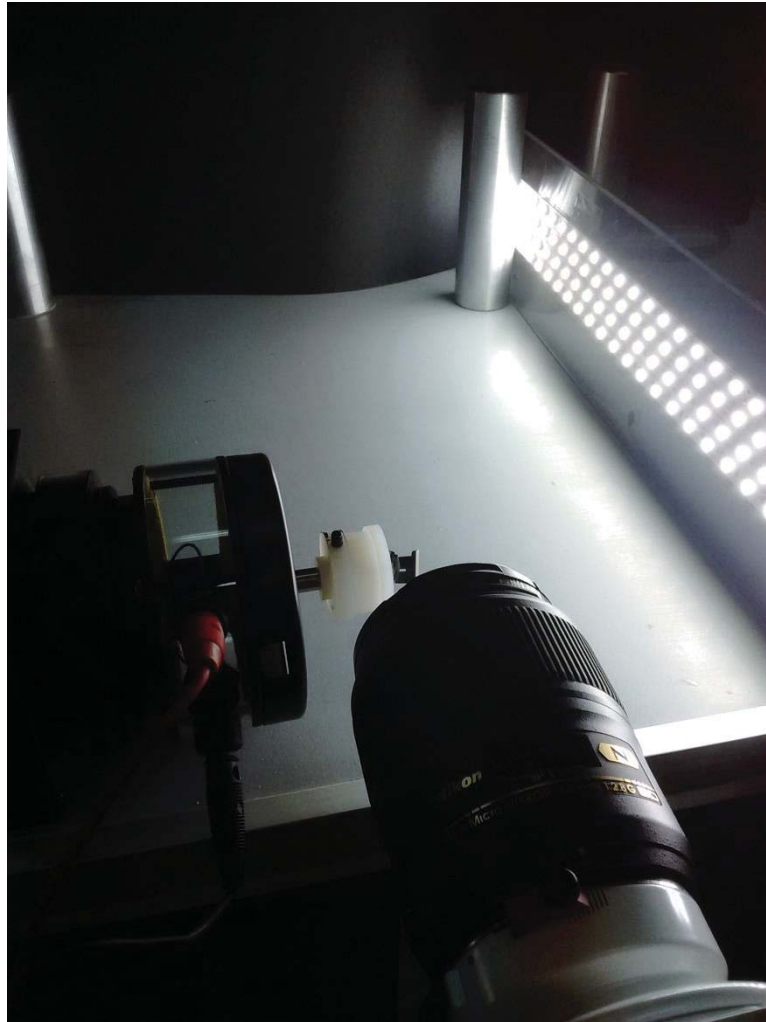
Figura 2-13: Cámara de alta velocidad apuntando a shaker Pasco instalado de forma horizontal, alumbrado por luminarias LED y con fondo color negro.
