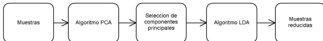
**Fig. 3-3 Esquema funcionamiento PCA+LDA**
