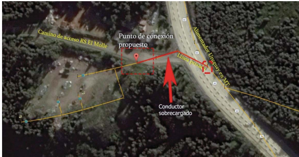
Figura 4-17 Tramo de conductor sobrecargado de alimentador privado (Fuente: Elaboración propia).
