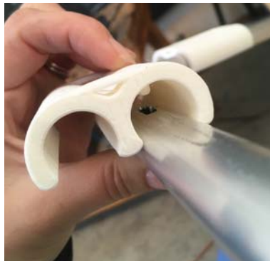
Forma de entrada de la pieza al tubo de aluminio.
