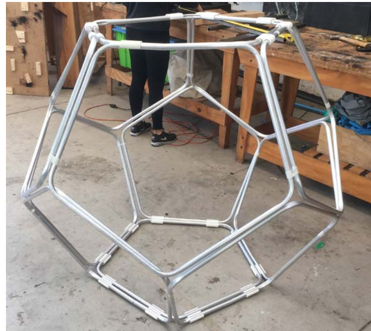
Esqueleto prototipo 1:1 armado con los pivotes base.
