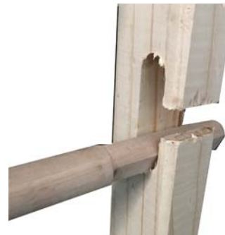
2. Ángulo que entra el travesaño en el sacado 4. Travesaño fijo en la parte de abajo del corte
