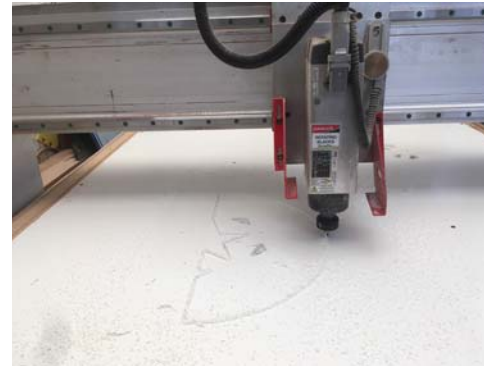
Corte CNC router del trovicel
