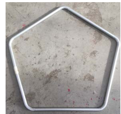
Proceso de curvado en la máquina. Es necesario un nivel para que quede todo en un mismo plano.
