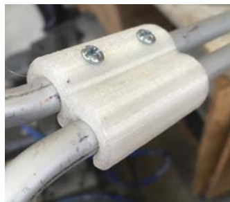
Pieza con las dos entradas a presión del tubo correspondiente en dos aristas.
