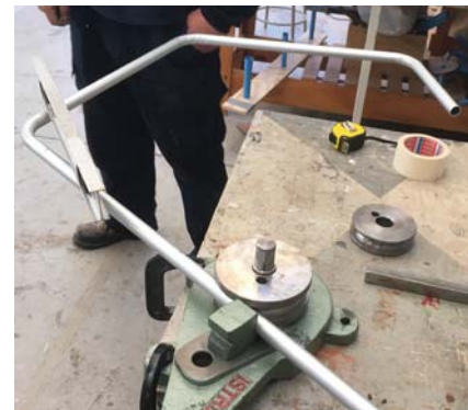
Proceso de curvado en la máquina. Es necesario un nivel para que quede todo en un mismo plano.
