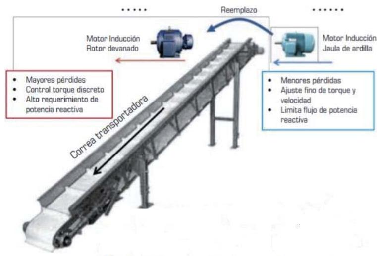
Figura 4-1. Reemplazo de motor de inducción con rotor devanado por motor jaula de ardilla
