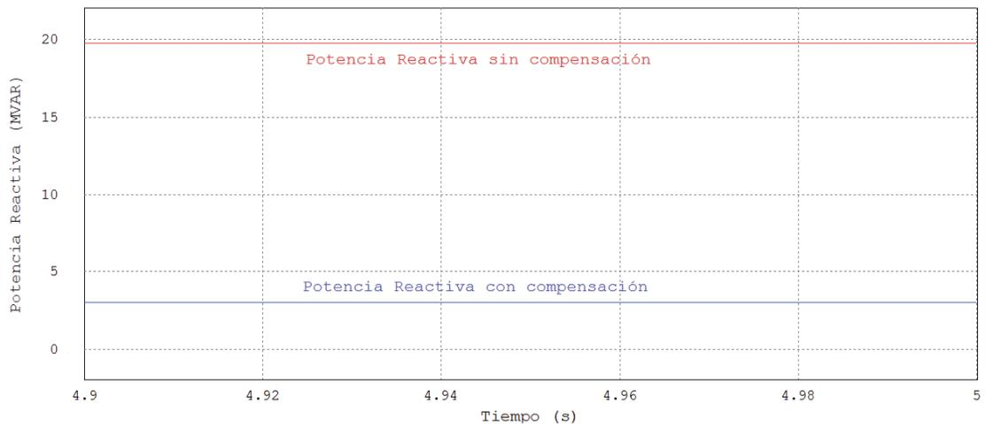
Figura 3-12 Potencia reactiva en SEP sin compensar (mayor), y en SEP con compensación (menor).
