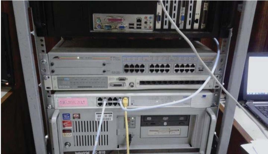
**Fig. 4.4** Equipo de red (HUB) del laboratorio de sistemas digitales. (Fuente: Elaboración propia)
