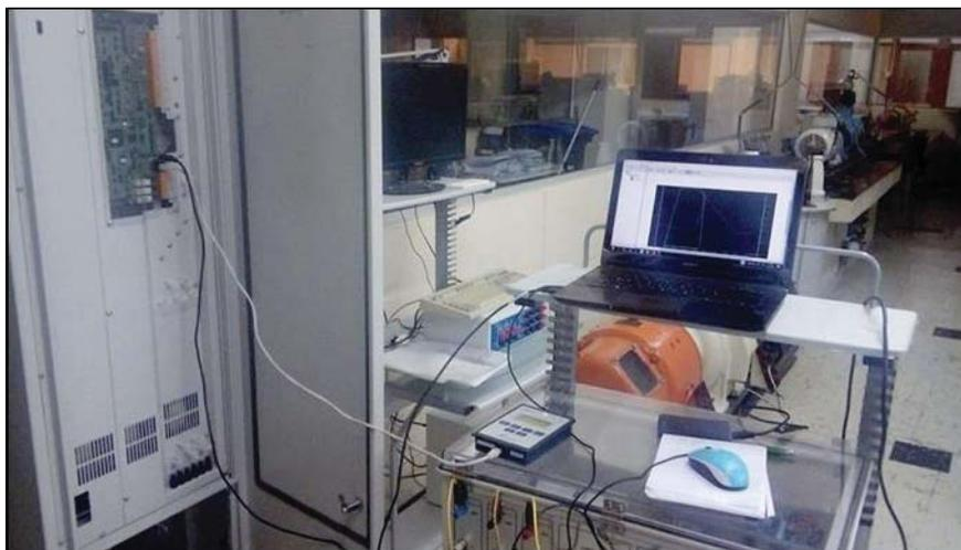
Figura 4-26: Conexión de Computador por cable UDB con VDF SD700
