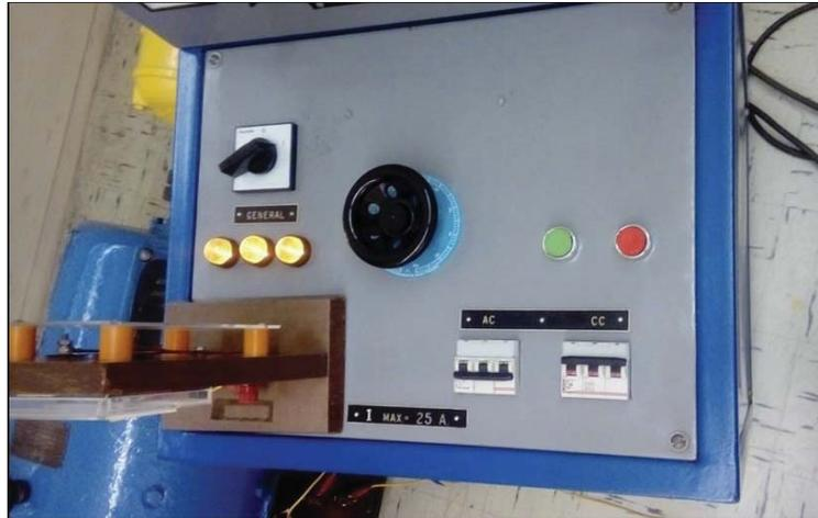
Figura 4-19: Fuente utilizada para incrementar progresivamente la tensión AC
