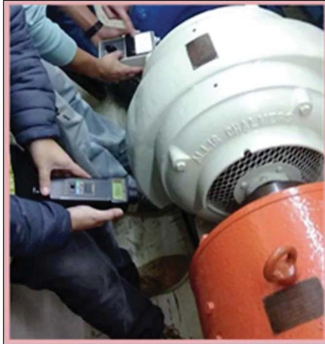
Figura 4-13: Medición con Tacómetros la velocidad del rotor
