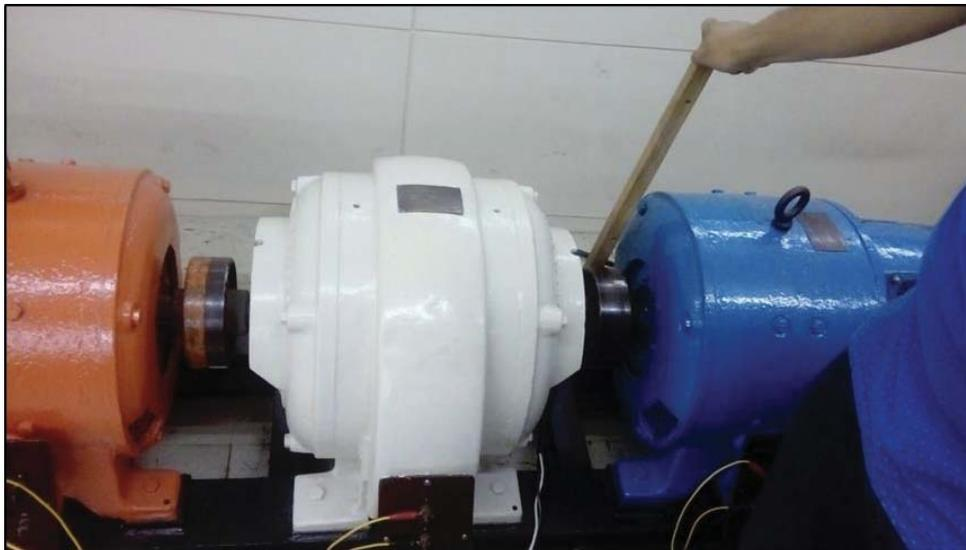
Figura 4-18: Bloqueo del rotor con palo de madera
