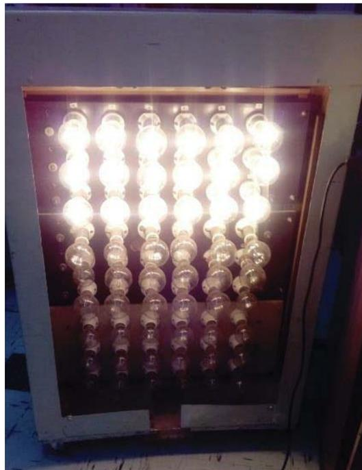
Figura 4-24: Carga Resistiva Conectada
