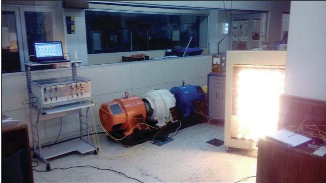
Figura 4-21: Equipos y carga conectada al generador CC
