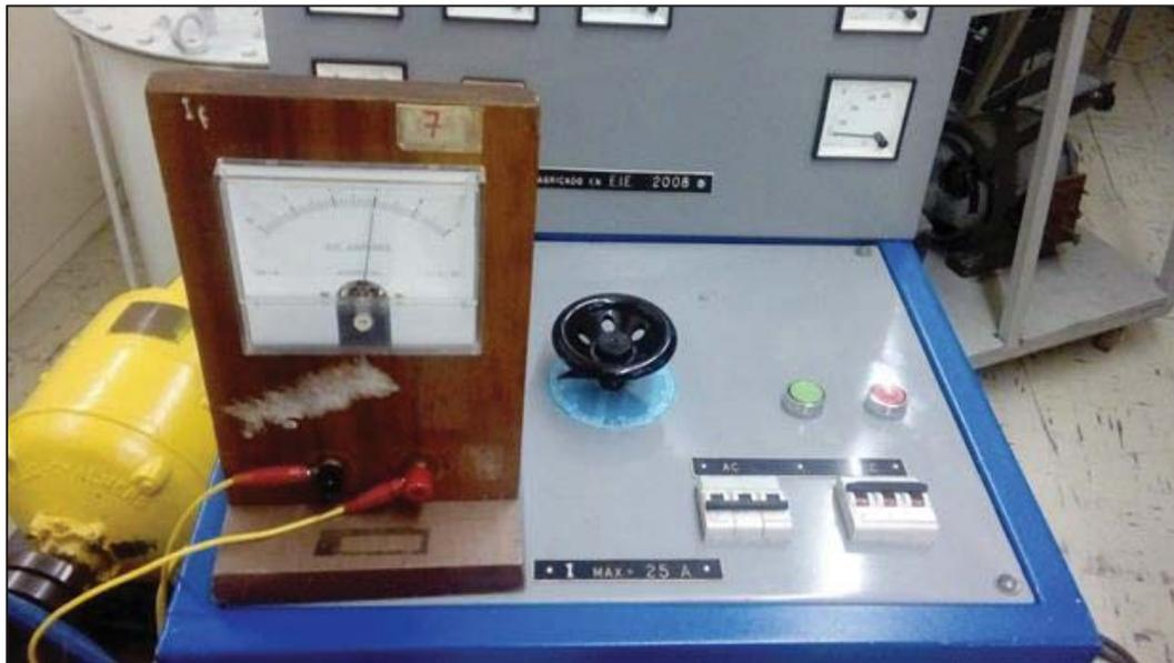
Figura 4-22: Fuente CC Variable con amperímetro para registrar Corriente en Campo
