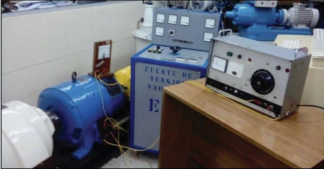
Figura 4-16: Fuentes de CC, para energizar la máquina de Corriente Continua
