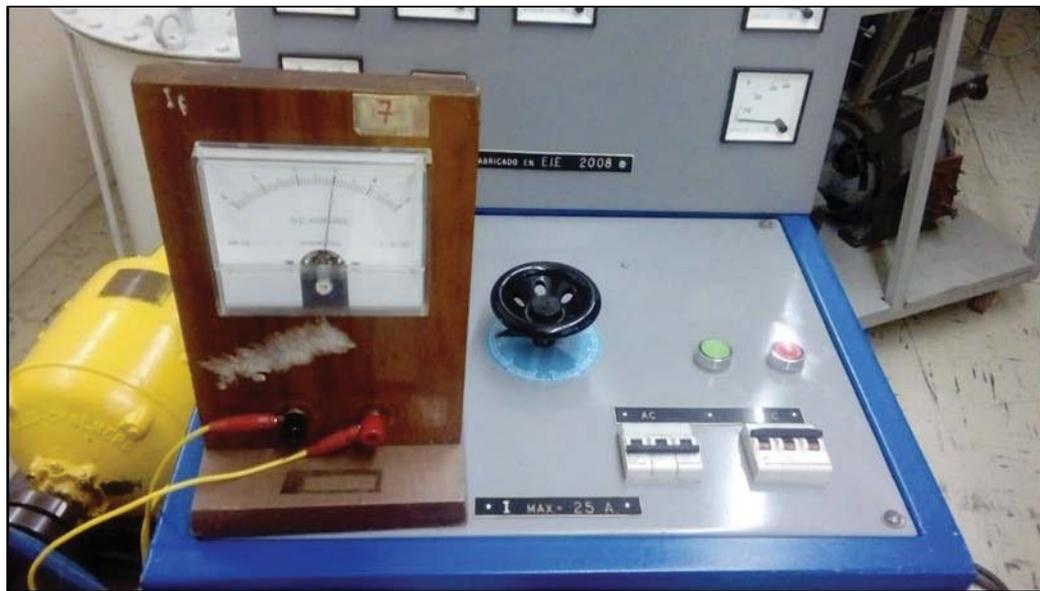
Figura 4-17: Amperímetro para verificar la corriente en el Estator de la máquina
