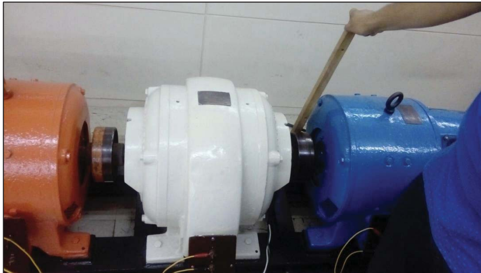
Figura A-18: Bloqueo del rotor con palo de madera.
