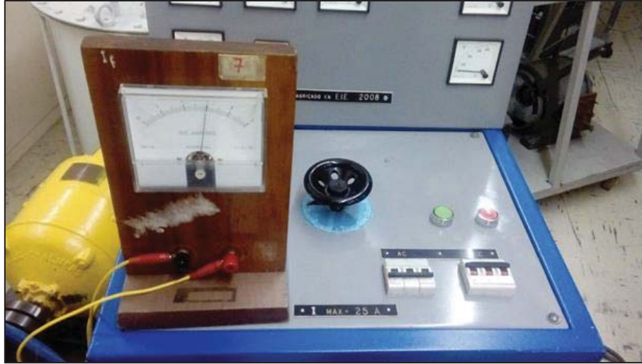
Figura A-22: Fuente CC variable con amperímetro para registrar Corriente en Campo
