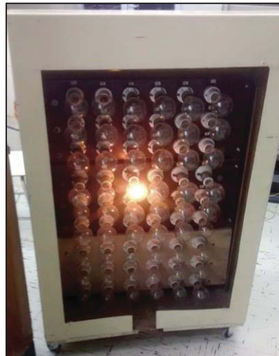
Figura 4-13: Carga resistiva de 200 [W]
