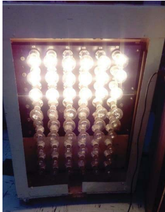
Figura A-24: Carga resistiva conectada.
