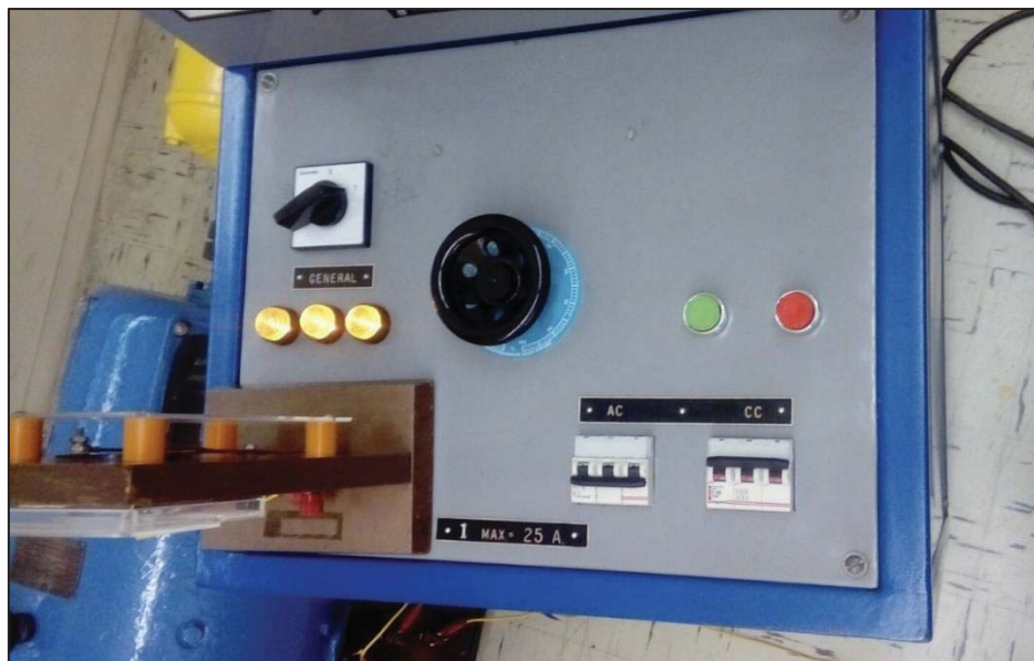
Figura A-19: Fuente utilizada para incrementar progresivamente la tensión AC.
