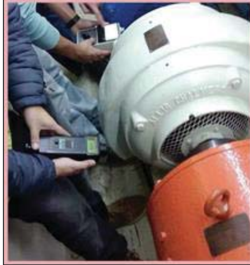
Figura A-13: Medición con Tacómetros.
