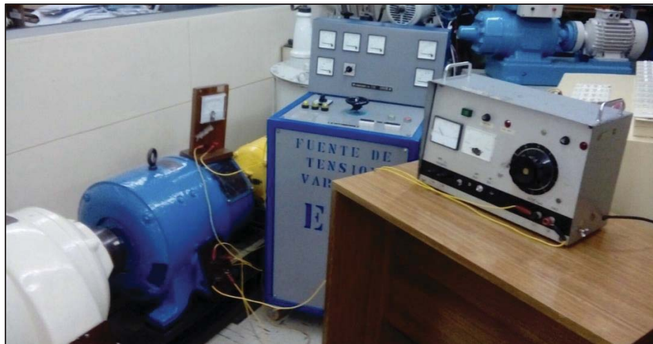
Figura A-16: Fuentes de CC, para energizar máquina de Corriente Continua
