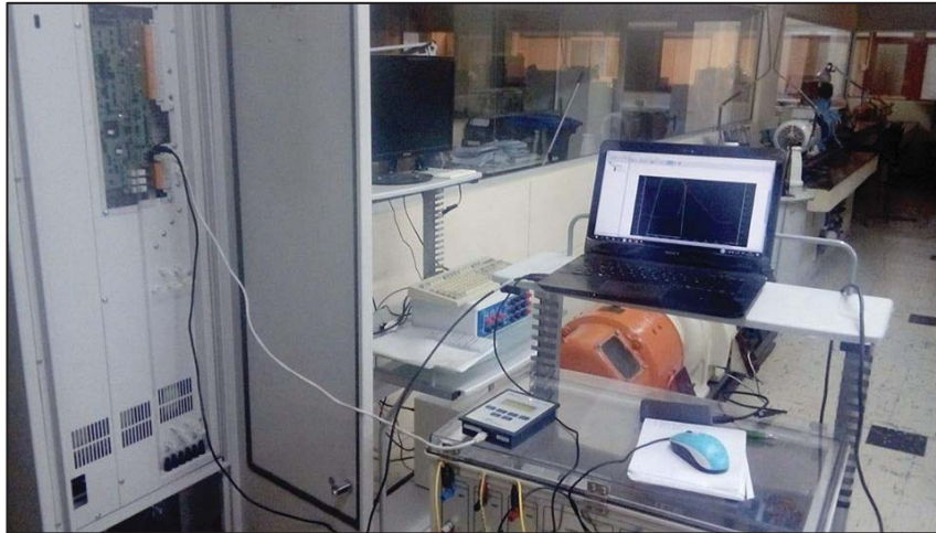
Figura A-26: Conexión de computador por cable USB con VDF SD700
