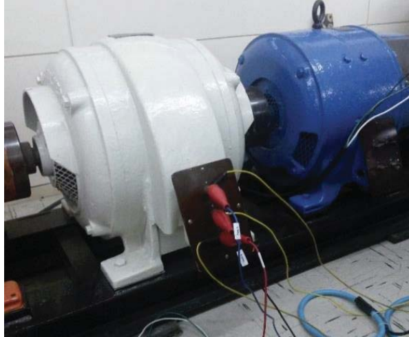
Figura 4-1: Motor de inducción de 30 Hp a utilizar
