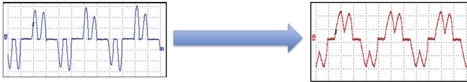
Figura 2-7: Izquierda forma de onda sin reactor. Derecha forma de onda con reactor a 3%. [7]
