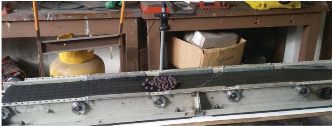
Figura 4-2: Cinta transportadora a escala implementada.
