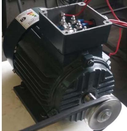
Figura 4-5: Motor trifásico.
