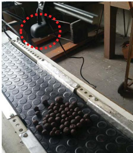
Figura 4-7: Sistema de adquisición de imágenes..
