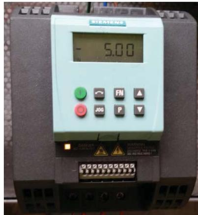
Figura 4-4: Variador de frecuencia siemens G110.
