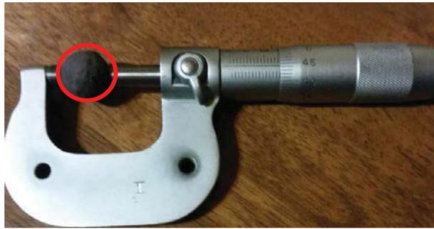
Figura 5-1: Medición de pellets de hierro.
