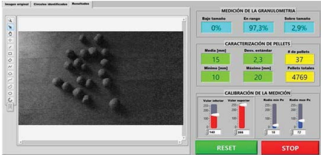
Figura 5-6: Resultados primera prueba dinámica..
