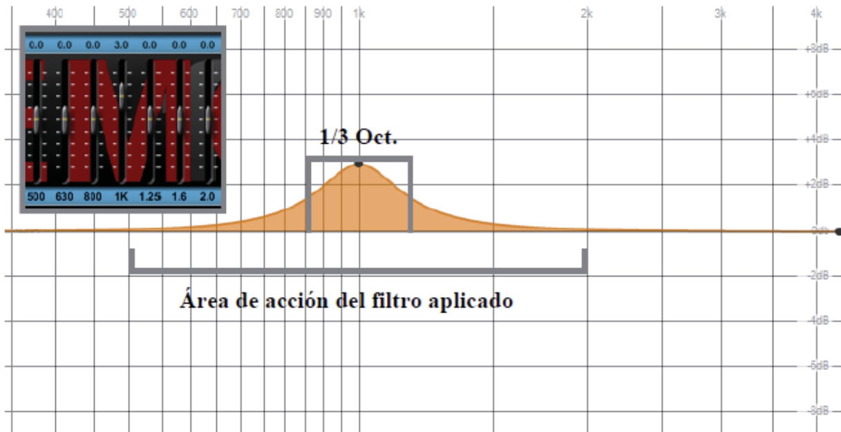
Figura 4.7 Énfasis de 3 dB en banda de 1KHz
