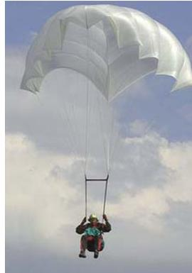
El **paracaídas**, artefacto diseñado para amortiguar los choques provocados por una caída. Un paracaidista se lanza desde el avión, tira del cordón de apertura tras 3 segundos. Esto permite al paracaidista caer lo suficientemente lejos como para asegurarse de que el avión no estorbe la apertura del paracaídas. Una vez abierto, la persona desciende a unos 5,2 m/s, y llega al suelo con un impulso menor que si hubiera saltado desde una altura de 3 metros.
