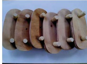
Se necesita una pieza para apretar y dejar fija la malla rachel en el travesaño de los parantes luego de estar instalada a 3 m de altura, para que no se corra ni se mueva con el viento poniendo en riesgo la tensión de las mallas.
