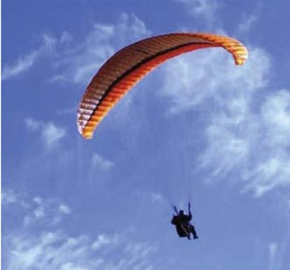
El **parapente** (Paracaídas en pendiente), es un planeador ligero flexible, no tiene motor, ni partes rígidas que compongan el ala. El peso de todo el equipo, suele rondar los 25-30 kg. La Velocidad máxima: 50 kilómetros/hora. Velocidad mínima: 24 km/h, con una relación de planeo de 10:1, es decir que por cada 10 metros de aire que avanza se desciende uno. Se trata de poder despegar, volar y aterrizar con un ala flexible a pie.
