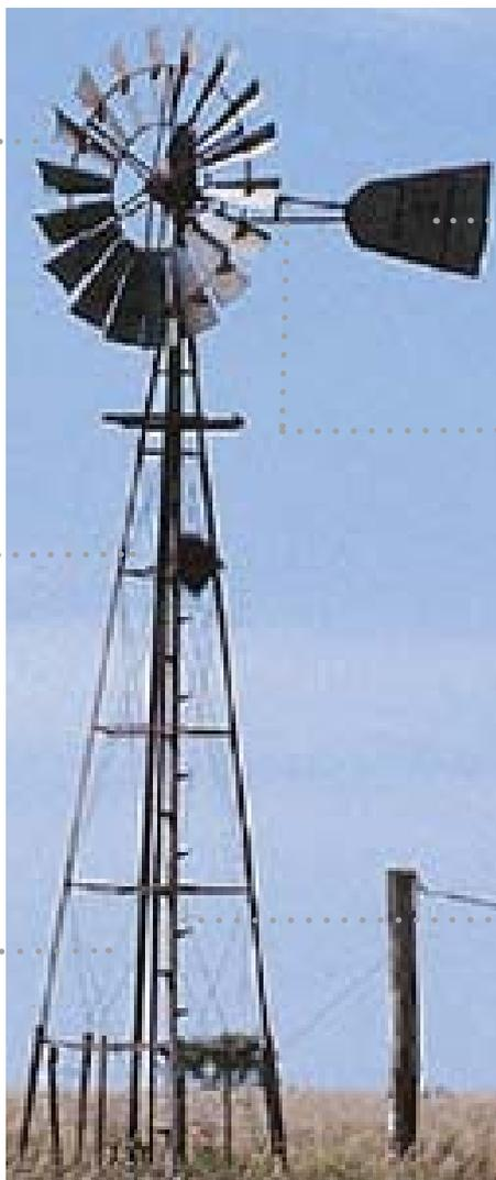
La veleta es una pieza metálica de chapa galvanizada de forma aerodinámica, que se coloca junto al rotor, de modo de orientarlo contra el viento incidente, su largo aproximado es de 1.20 m.
