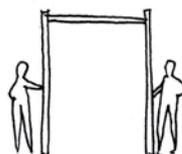
12:30 Dos personas se ubican en la mitad del largo de la malla, uno en cada lado sujetando el parante que está por debajo de ésta, y se levantan deslizándolos hacia los extremos hasta dejar la malla lo suficientemente estirada y tensada. La misma faena se hace en los dos extremos de la malla.
