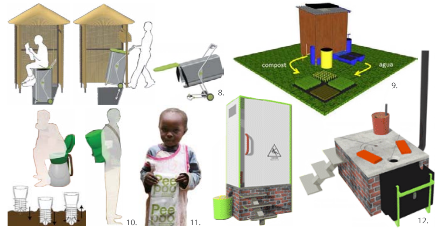
8. Proyecto de la rumana Oana Blei, inodoro móvil para África. 9. BIS (Baños Integraes Sustentables)/ Baños completos de bajo costo, incorporan distintas tecnologías, como separación de líquidos y sólidos, cámara de compost y calentador de agua solar para ducha y lavamanos. 10. Dignidad/ Baño móvil, posee la capacidad de almacenar desechos para hasta 4 individuos, de 4 a 7 días, para luego ser "atornillado" manualmente al suelo, fertilizándolo. 11. PeePoole/ Bolsa biodegradable para contener materia fecal y evitar la propagación de enfermedades. 12. WWC (Without Water Closet)/ Letrina, separa sólidos de líquido, generando compost. Incorpora además un tubo ventilador.
