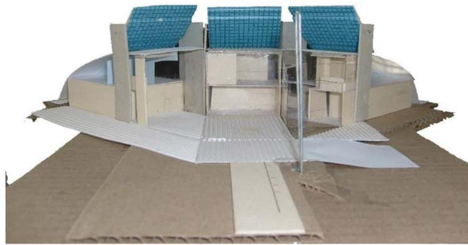
Maqueta en esc. 1-100, sometida a pruebas de viento para verificar el funcionamiento del alerón.
