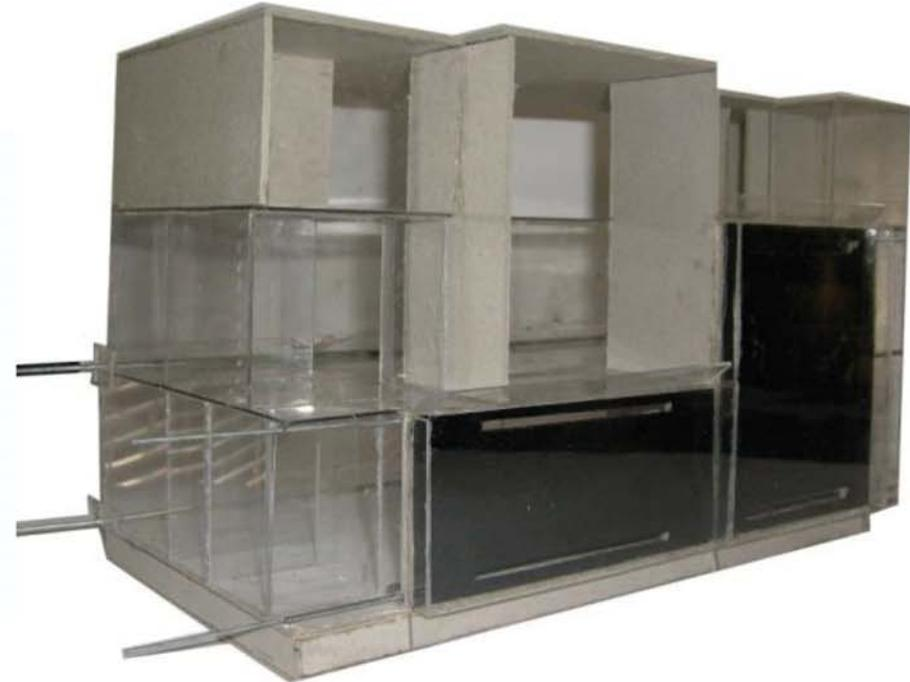
PRUEBAS CALEFACCIÓN-VENTILACIÓN MAQUETA ESC. 1-50
