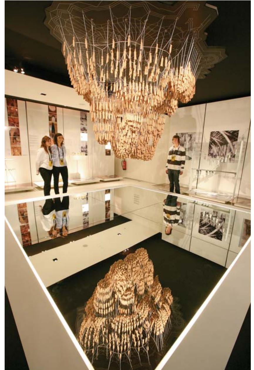
Arcos funiculares de la catedral de La Sagrada Familia, Barcelona. Gaudí introdujo este tipo de arco al suspender diferentes cargas puntuales sobre la base del arco catenario, una construcción matemática de arco poco usada hasta entonces. Invertiendo el resultado de este ejercicio de cargas se obtiene una estructura que, manteniendo una orientación vertical, resulta apta para la construcción.
