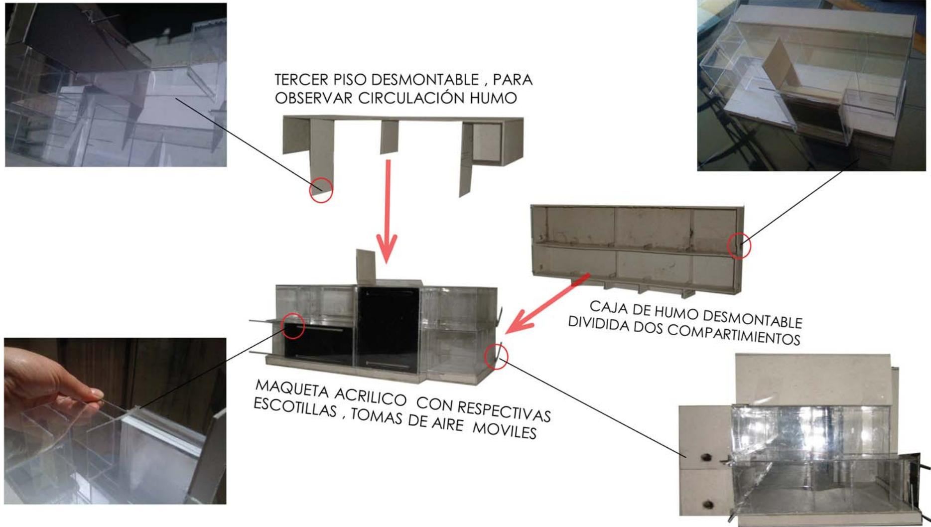
**PRUEBAS CALEFACCIÓN-VENTILACIÓN MAQUETA ESC. 1-50**
