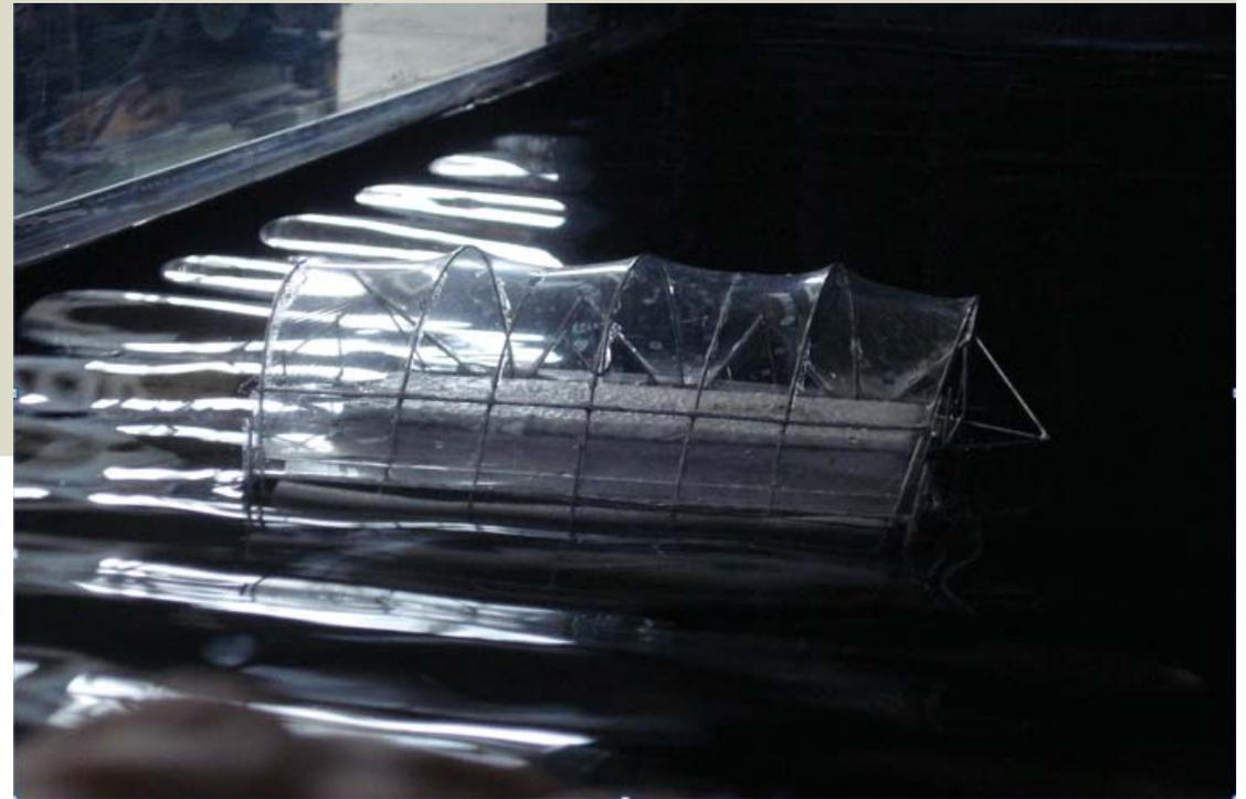
Figura 70. Modelo Físico Capitanía de Puerto para de Pruebas Hidrodinámicas. Fuente: Miguel Oviedo.
