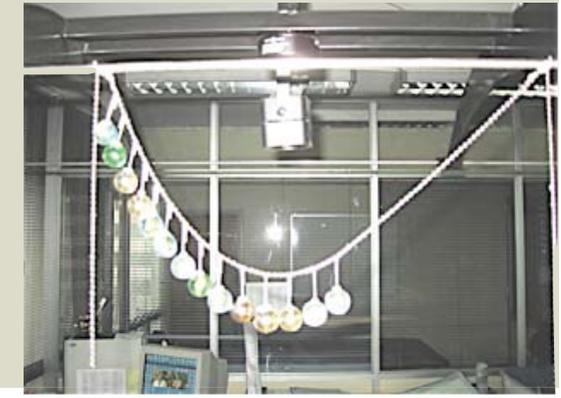
En el modelo 2 se necesitaba conseguir un manto asimétrico en el estudio de los polígonos foliculares descubrimos que si se inclinaba el horizonte de estos lográbamos la figura que buscábamos y así marcamos esta representación sobre un papel y utilizamos escalado esta figura para decir el nuevo manto, así nos asegurábamos que teníamos una catenaria.
