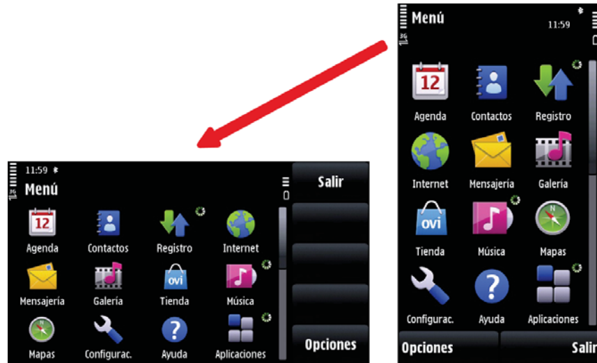
Figura 6.3: DMT2 - Nokia X6: Modo landscape u horizontal. Inclínación detectada por el acelerómetro del equipo.
