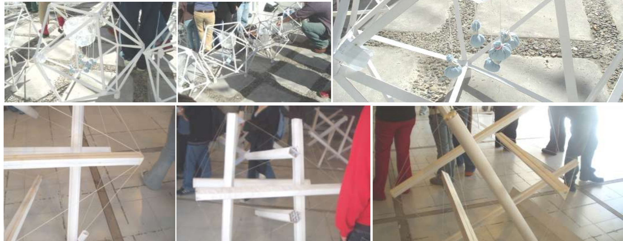
Arriba; diseño y construcción icosaedro que sostiene catenaria. Abajo; diseño y construcción tensegrity de Füller hecho de papel
