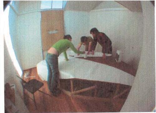
Una vez puestos los ojettillos se ubican las secciones del manto sobre un caballete especialmente construido para esta faena y se pegan los bordes, en un ambiente "controlado".
