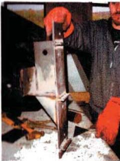
Corte de las pletinas (ferro de 100 x 8 mm), en secciones que van desde los 576 mm a los 30 mm, el corte debido a su precisión se realiza en una galleta de mesa.
