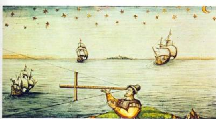
Figura 21. Manejo de la Ballestita para el cálculo de la situación por la altura de los astros.
