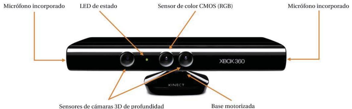
Figura 2-2: Distribución externa de Kinect (fuente: <http://www.elotrolado.net/>)
