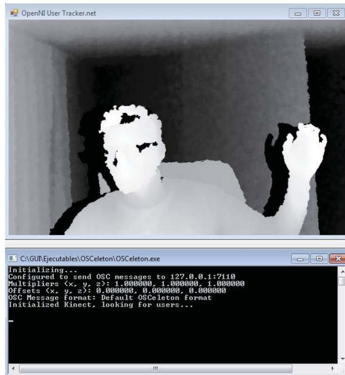
Figura 3-9: OSCeleton en ejecución (fuente: elaboración propia)
