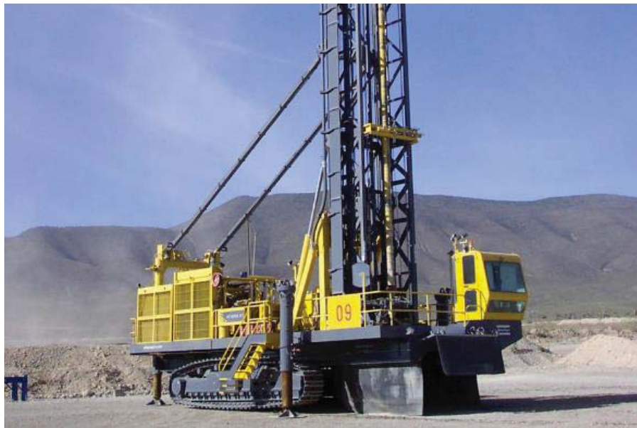
Figura 2-8: Perforadora PIT VIPER 351 de ATLAS COPCO – Fuente, Codelco Andina.
