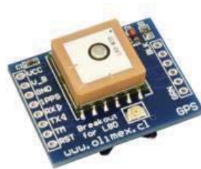
Figura 2-8 Tarjeta GPS L-80 (fuente: https://www.olimex.cl )
