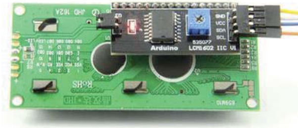
Figura 3-20 Conexión LCD y Modulo i2c (fuente: http://www.geeetech.com )
