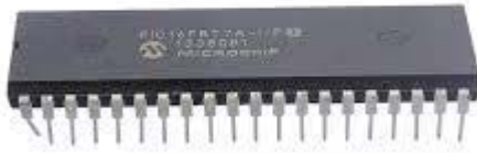
Figura 2-18 Microcontrolador de la familia 16F de Microchip (fuente: http://www.microchip.com )
