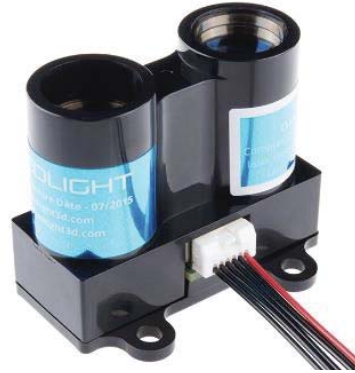
Figura 2-11 Sensor Lidar Lite V2 (fuente: https://www.sparkfun.com )
