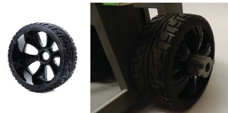
Figura 3-33 Rueda de plástico- caucho usada en la plataforma
