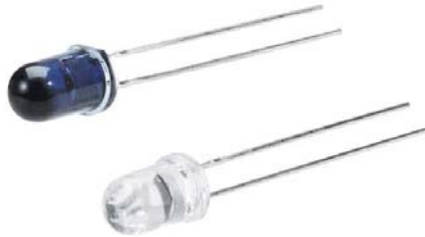
Figura 3-9 Emisor y receptor infrarrojo de 5 mm.
