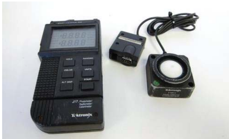
Figura 2-23 Luxómetro Tektronix con filtro de medición. (fuente: http://www.tek.com )
