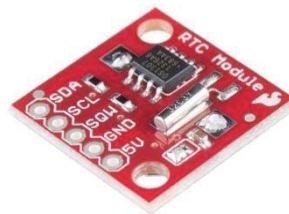
Figura 3-5 RTC DS1307 (fuente: http://tienda.bricogeek.com )
