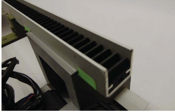
Figura 3-28 Vista real de la cremallera incorporada al perfil
