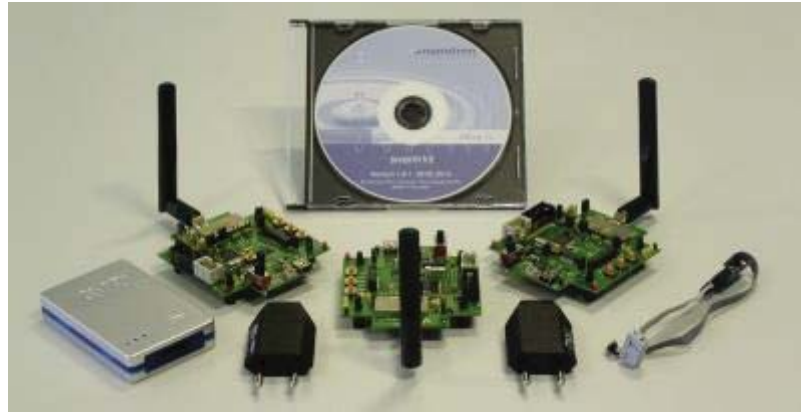
Figura 2-12 Tags y anclas Nanotron (kit RTLS). (fuente: https://www.nanotron.com )
