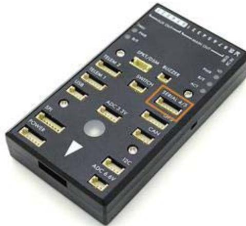
Figura 4-11 Puerto Serial 4/5 (fuente: [www.ardupilot.org](http://www.ardupilot.org)).
