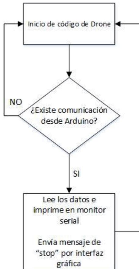
Figura 5-4 Diagrama agregado a código de Drone.
