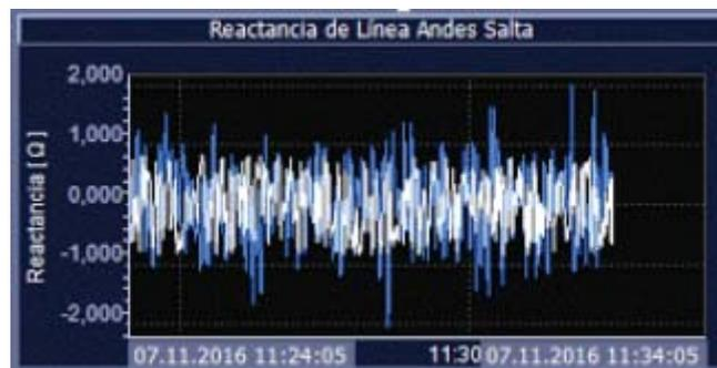
Figura 6-28 Resultados de reactancia en tiempo real con PMU's simuladas en la red WAM del CDEC-SING considerando el bloque existente en la plataforma y el desarrollado
