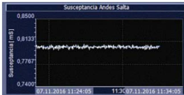
Figura 6-29 Resultados de susceptancia en tiempo real con PMU's simuladas en la red WAM del CDEC-SING considerando el bloque existente en la plataforma y el desarrollado
