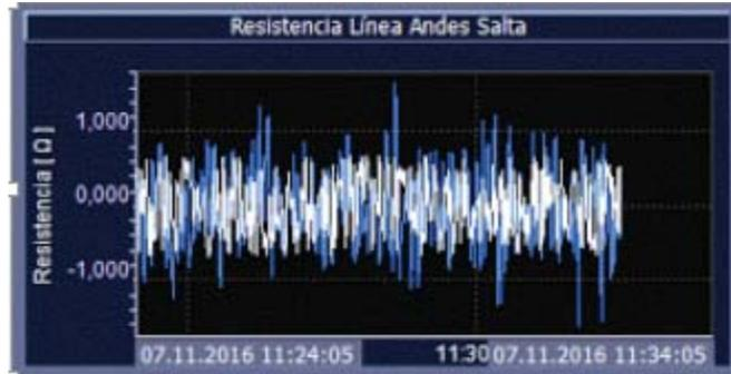
Figura 6-27 Resultados de resistencia en tiempo real con PMU's simuladas en la red WAM del CDEC-SING considerando el bloque existente en la plataforma y el desarrollado
