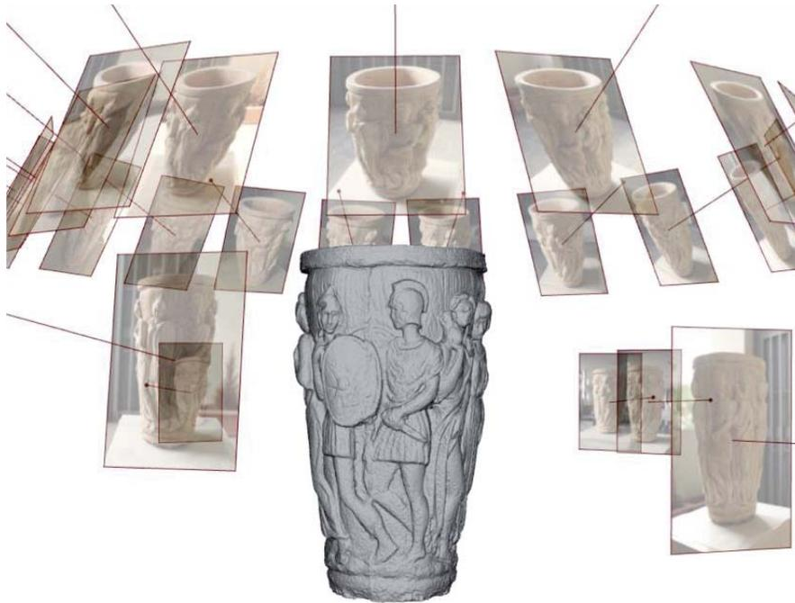
Figura 3-1 Modelo 3D CAD creado con técnica fotogramétrica [9]
