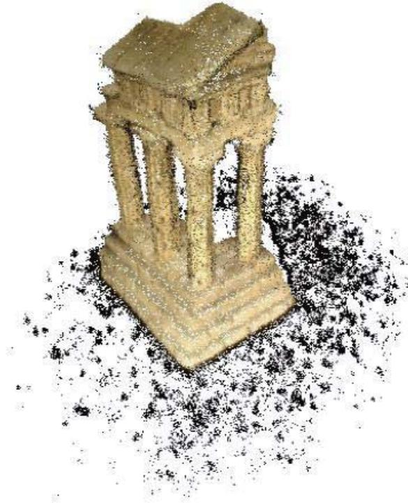
Figura 3-4 Nube de puntos densa obtenida en el proceso Multi-View Stereo [10].
