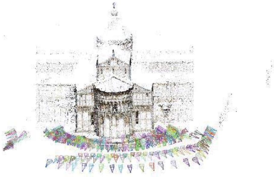
Figura 3-3 Nube de puntos no estructurada y posicionamiento de cámaras [10]
