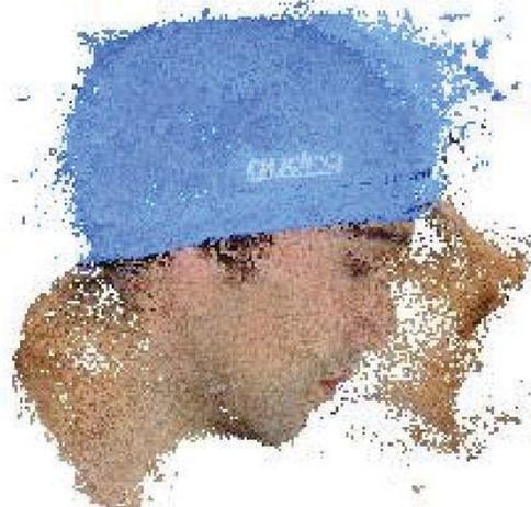
Figura 5-7 Error en modelo 3D CAD causado por simetría.
