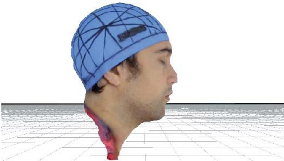
Figura 5-8 Error de modelo 3D por falta de traslape en la nariz.
