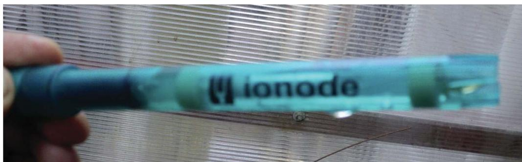
Fig. 2-3 Electrodo de pH Ionode IH-20
