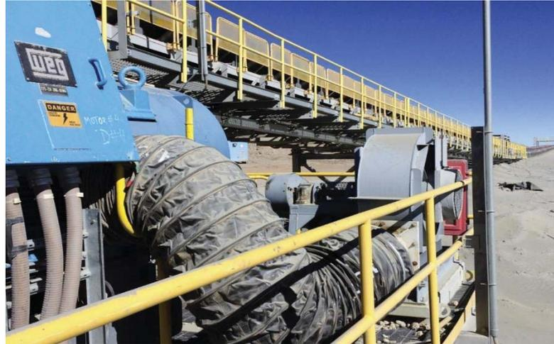
Figura 6-10 Sistema de ventilación forzada
