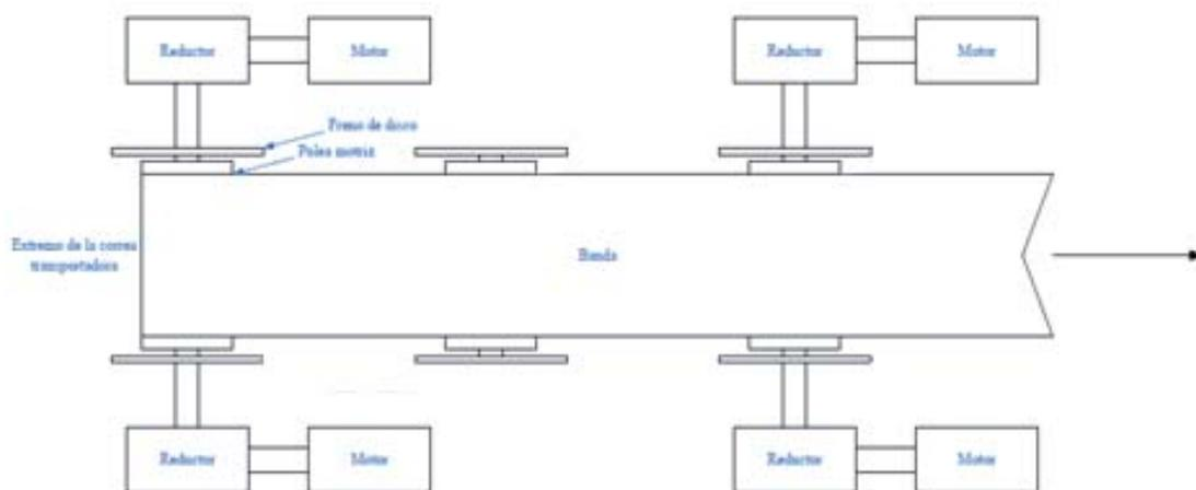
Figura 8-1 Detalle de motores en correa
