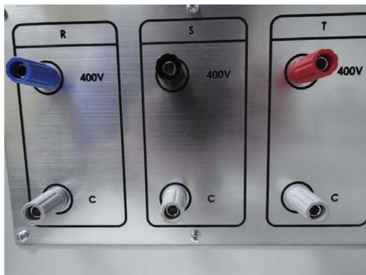
**Fig. 2-10 Colores bornes para canales de tensión**
