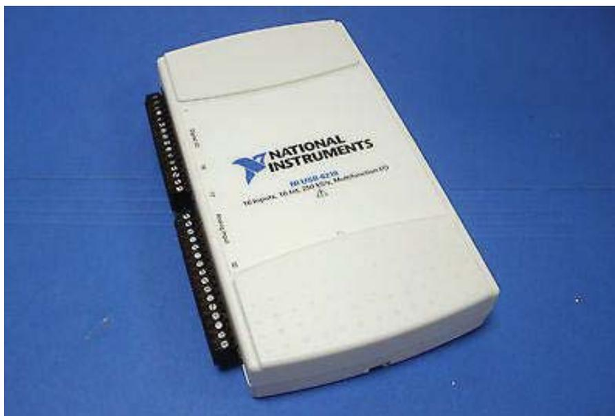
**Fig. 2-1 Módulo NI USB-6210**
