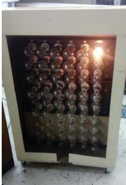
Figura 4-10: Panel de ampollitas, con una encendida para llevar a cabo el frenado
