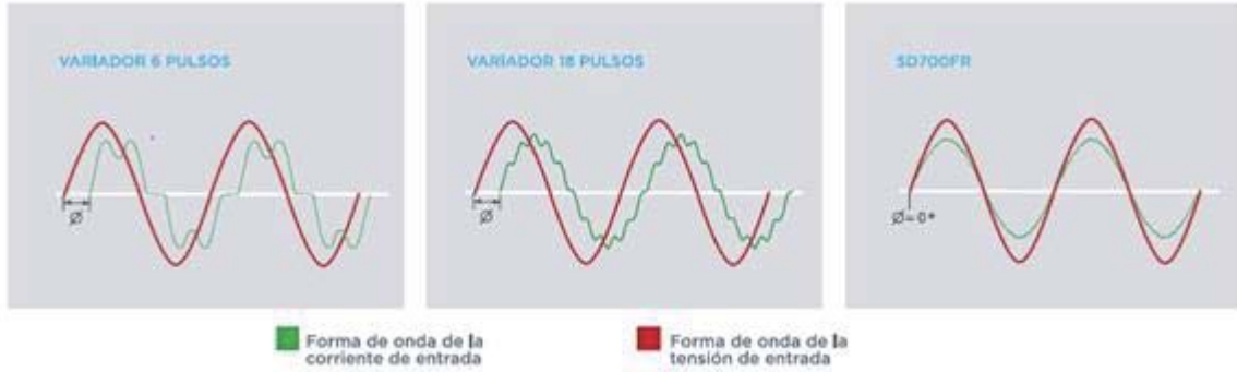
Figura 2-11: Formas de onda de tensión y corriente, con distintos rectificadores (fuente: : http://power-electronics.com )
