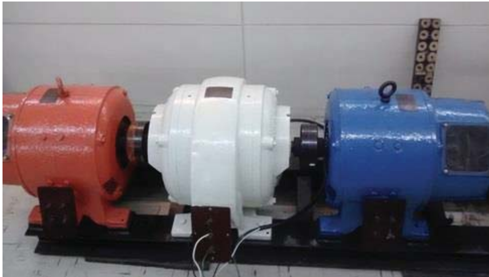
Figura 4-1: Motor de inducción (blanco) acoplado desde su eje a una máquina de CC
