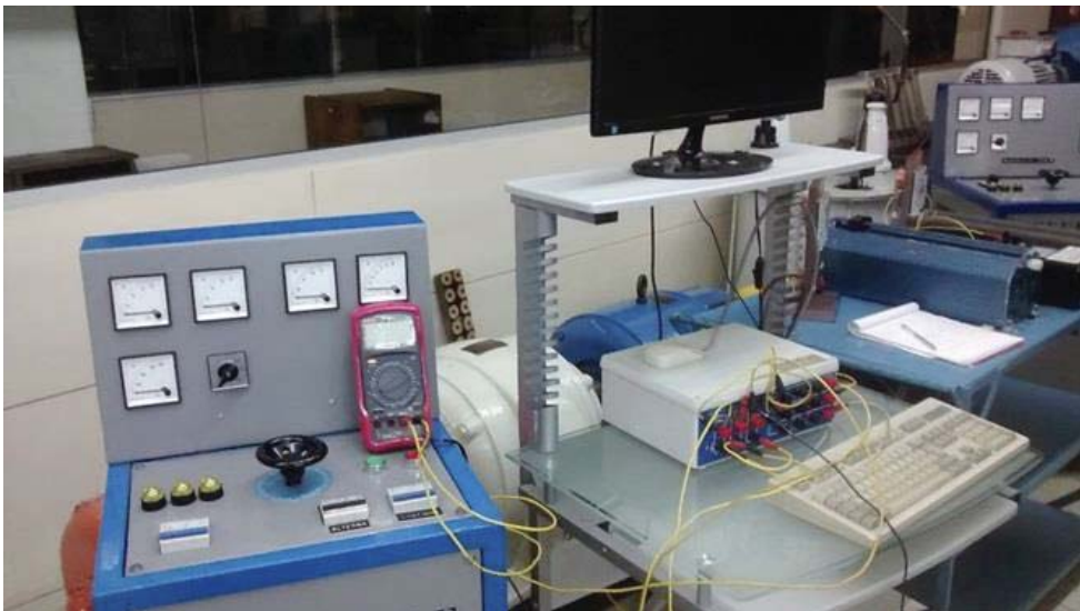
Figura 4-2: A los extremos se muestran dos fuentes de tensión regulable, la de la izquierda acciona al motor de inducción y en el de la derecha acciona el motor de CC, en el centro se encuentra el equipo Samte
