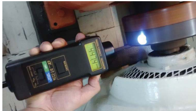
Figura 4-9: Registro de la velocidad del rotor con un tacómetro digital
