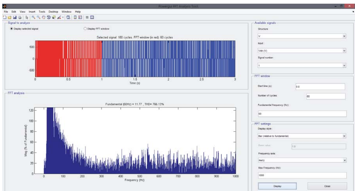
Figura 3-8: Análisis de Fourier a través del bloque Powergui para el primer segundo de simulación
