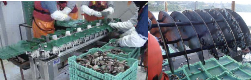
Figura. 28: Máquina calibradora (izquierda). Linterna en desdoble (derecha).
