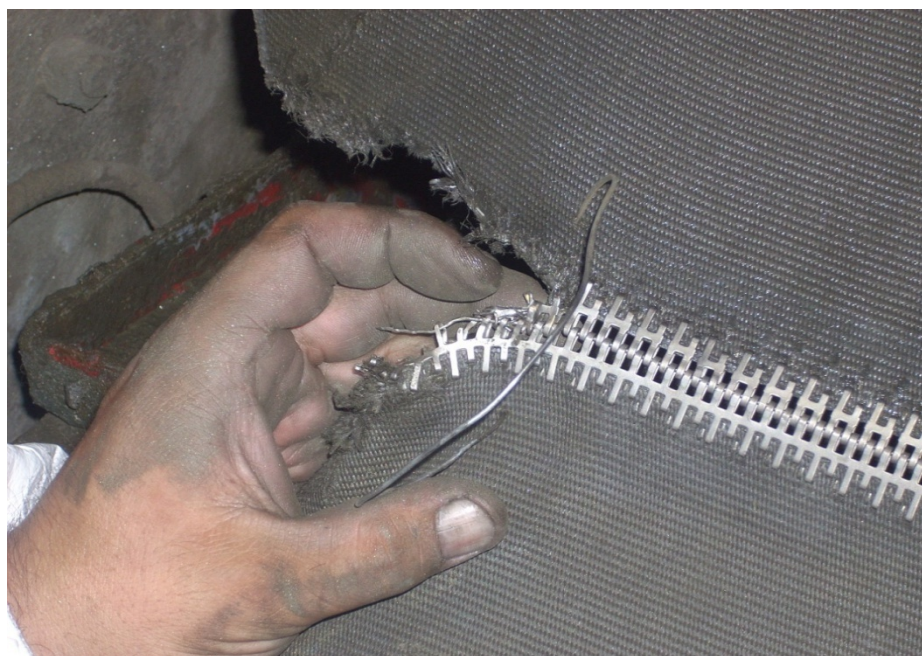
Figura 25: Ruptura gancho metálico
