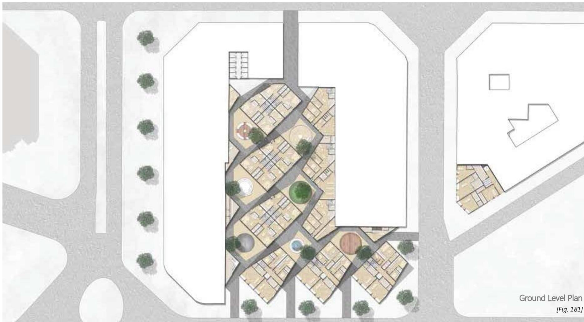
La diagramación del proyecto surge de varios ensayos de trazos sobre el terreno. Finalmente se obtiene el trazado a partir de las ochavas de cada manzana del Ensanche: tomando ese trazo y repitiéndolo sobre el sitio.
