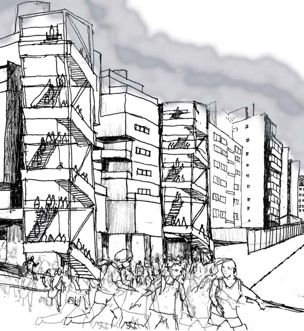
Evacuación vertical expedita durante un tsunami mediante cajas de escaleras que van desde el nivel calle hacia una altura segura.
