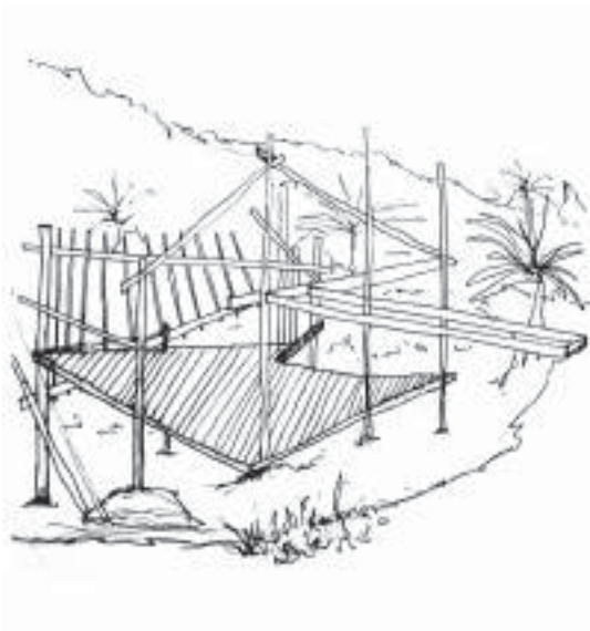
La punta de los rollizos delinean el límite máximo del cerro. Mayor altura de la obra, rematado por el fondo límite- cerro, calzando en la misma línea que él.
