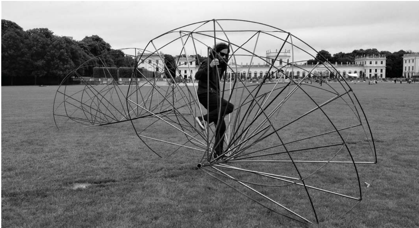
Prueba de giro del gajo, manejándolo desde dentro
