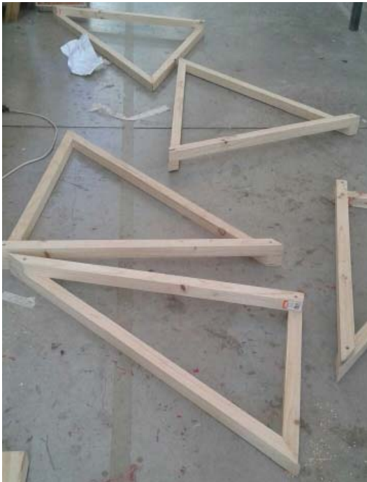
Triángulos de la matriz con sus ángulos correspondientes para formar la curva
