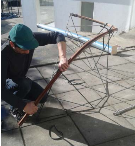
Prensado de los listones de raulí en la matriz, siguiendo la curva dirigida por los vertices del cuerpo de fierro
