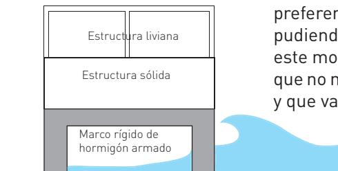
Otra medida tiene que ver con la estructura. Se recomienda que la primera planta del edificio sea preferentemente marco rígido de hormigón armado, pudiendo aliviarse hacia arriba en otros pisos. De este modo, el impacto de una ola lo reciben elementos que no necesariamente son estructurales, más frágiles y que van frenando el avance del agua.
