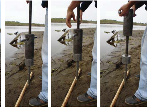
Secuencia para subir el peso hasta la altura deseada.
