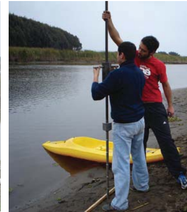
Es necesaria la participación de un segundo integrante para ayudar a mantener la varilla en posición vertical.
