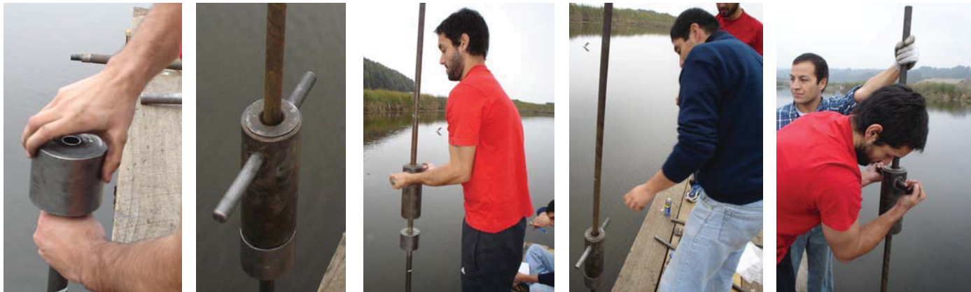
Detalle del tope y del peso situado sobre él
