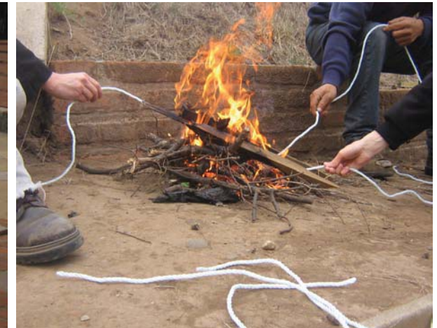
Cauterización de los extremos de las cuerdas
