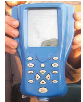
computador especializado que registra los golpes y la profundidad que va alcanzando la vara
