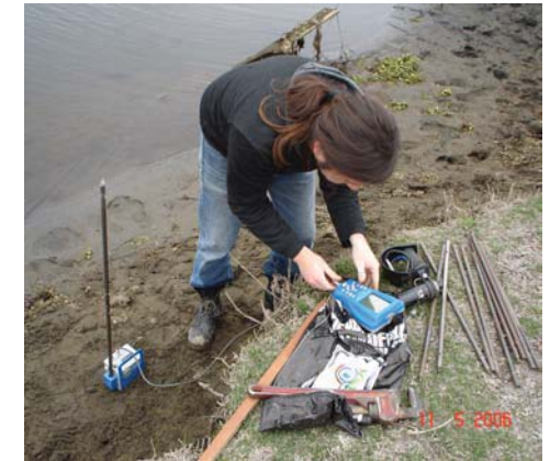
En este caso, el ensayo se realiza estando al mismo nivel del terreno a analizar 3.1.2. PENETRACIÓN ORILLA NORTE DEL ESTERO
