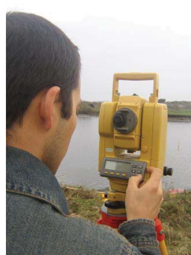
Antes de comenzar, se deben fijar las coordenadas del lugar en donde se encuentra el instrumento.
