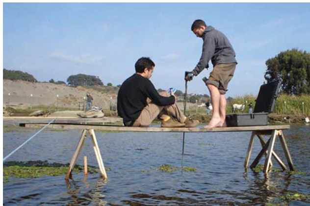
Estructura utilizada en el ensayo compuesta por tablas apoyadas sobre caballetes de madera.
