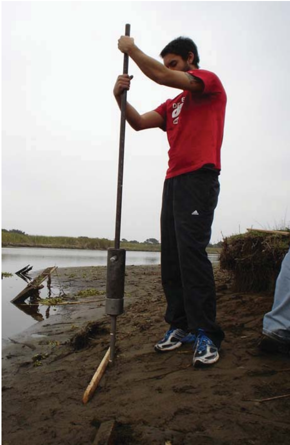
Detalle del punto exacto donde se realiza el segundo ensayo con el cono portátil.
