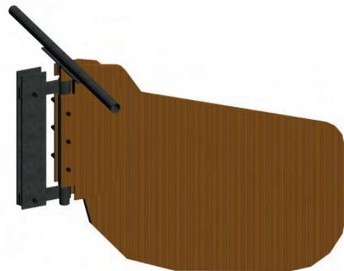
**13** Una vez ubicado el timón y el pedal, se procede a conectar los cables que vinculan ambos. Se conectan paralelamente para un funcionamiento correcto
