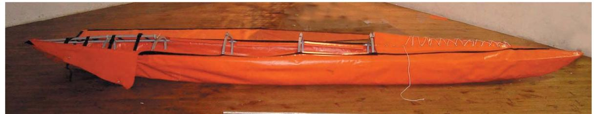
**9** Armar los tubos laterales de cubierta. Se instalan en la funda, cuidando de instalar simultáneamente las abrazaderas regulables. Se insertan en el bolsillo de la funda y en cada cuadernas (3,4,5,6) se ubican las abrazaderas.
