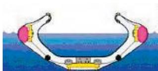
El aire que contienen los sponsons permite un menor esfuerzo en el armado de la estructura dentro del casco, máxima protección contra zozobrar y un fácil reingreso a la estabilidad boyante en caso de sumergirse.
