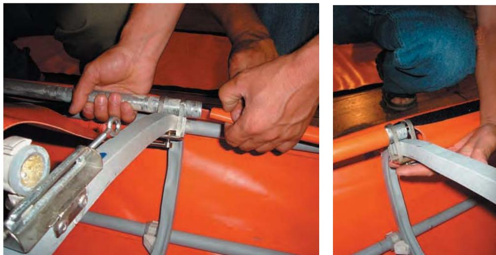
**10** Tensar transversalmente la funda. Se debe correr el tubo de traslape y girar el tensor hasta lograr una tensión adecuada. Luego volver a cubrir el tensor con el traslape.
