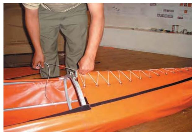
**12** Para tensar la sección central se debe tirar los tubos laterales de cubierta hacia el centro, corriendo con ellos las abrazaderas (estas deben estar con el hilo al máximo).
