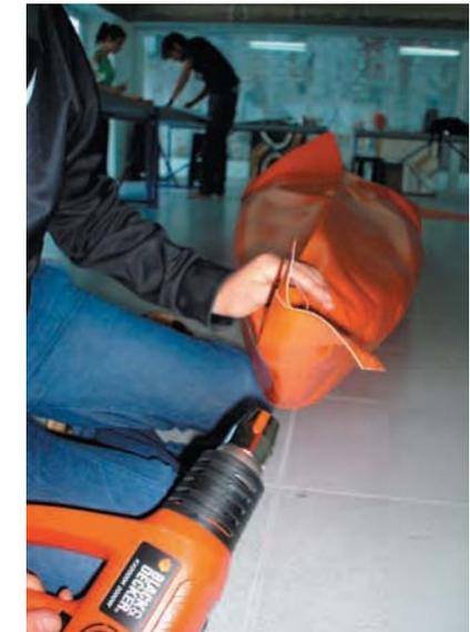
Una vez constituida esta zona, se procede a trabajar en la terminación de proa. La tela se tensa transversalmente mediante correas fijadas a ésta, en diversos puntos.
