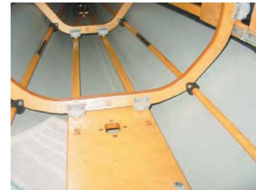
Desde abajo, insertar las dos varillas con ganchos dentro del conector (d) de madera de la pieza de la proa.
