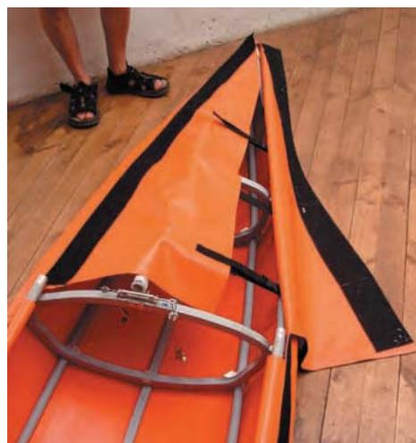
Fijación de correas para cerrar superficie cubierta
