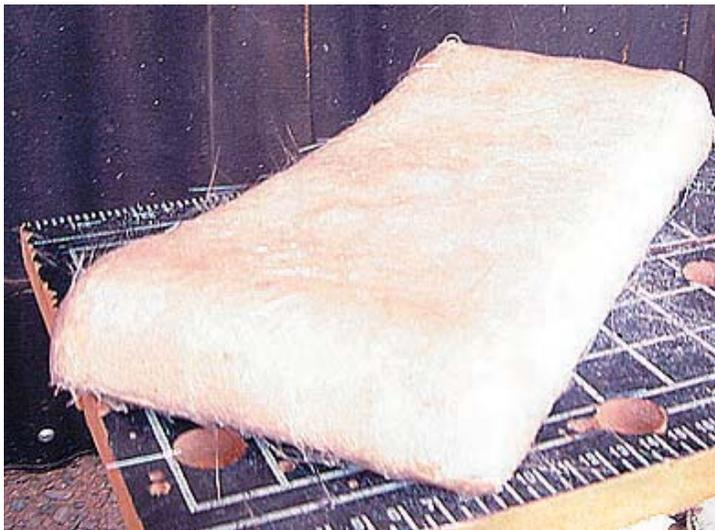
**4** Se cubren los cantos con mayor longitud mediante segmentos de fibra superpuestos para evitar superficies sin fibra. Para los vértices donde se encuentran ambas curvas se trabaja con segmentos pequeños y capas muy finas de fibra, dejando secar antes de aplicar la siguiente.
