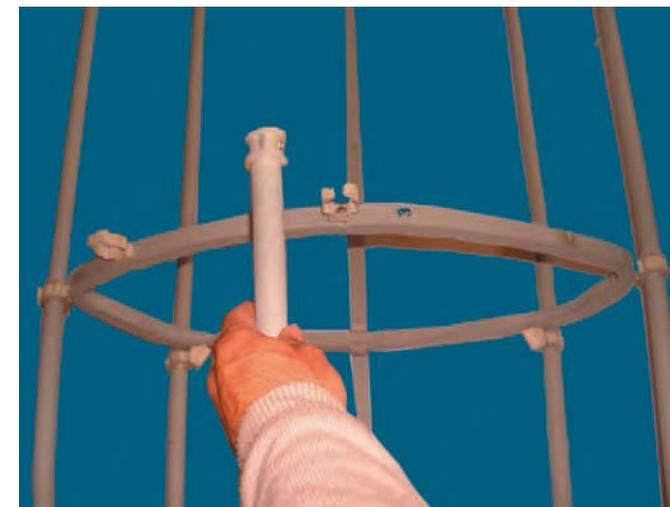
6 Una vez lista la estructura, extender la funda. Abrir la cubierta de popa, ampliar lo mayor posible la cavidad del habitáculo y proa. Insertar la estructura a la funda, de popa a proa. Cuidando la fuerza de inserción para evitar el daño de la funda con la roda de proa o roce.
