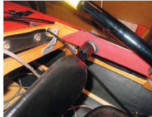
Los sponsons deben ser inflados hasta que la funda quede tensa en la sección de las cámaras de aire, con aproximadamente -10% de aire para que las alzas de temperaturas no excedan la superficie de las cámaras. El orden para inflar los sponson debe ser uniforme en cada lado. Una vez inflados cierre las válvulas. No utilizar compresor.
