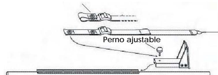
Las correas poseen perforaciones que regulan la longitud de los cables. Finalmente vincular los cables a las correas. Determinar la medida ideal mediante las hebillas.
