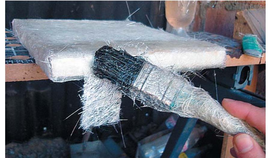
Recubrimiento de cantos mediante segmentos: primero se fijan a una superficie y se dejan secar, para luego adherir lo restante (canto y lado opuesto)
