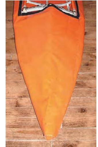
**14** Como elemento adicional se fabrica una cubierta para el área abierta de la embarcación. Consiste en un manto de tela de PVC con velcro. Posee en sus límites un velcro que permite instalar en la funda, al coincidir su perímetro con el establecido en la funda.
