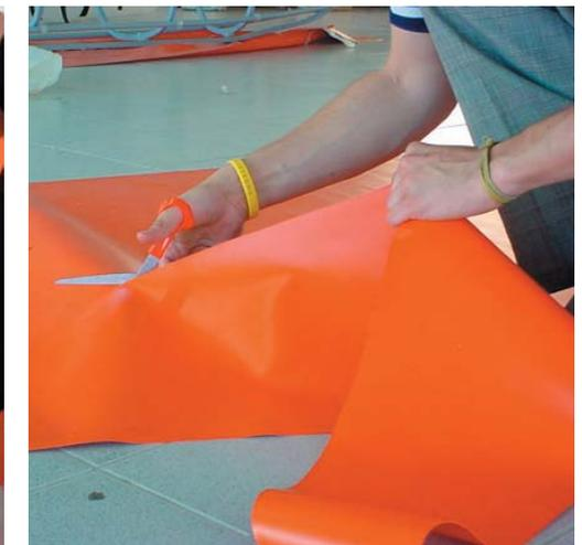
**Corte de secciones de la funda**
