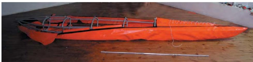
7 Cuando la estructura este inerta lo mayor posible en la funda, se debe tirar de popa para insertar el extremo de la roda. Se recomienda levantar la superficie de cubierta de popa para disminuir el esfuerzo.
