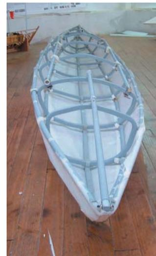
Casco: secciones quilla a tubos laterales superiores
