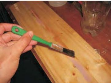
Ya se tiene el ala del tamaño y del perfil alar adecuado, pero esta estructura por si sola no es suficiente para soportar los esfuerzos, más bien es la estructura de soporte, la base para el paso que viene que es el revestimiento de fibra de vidrio.
