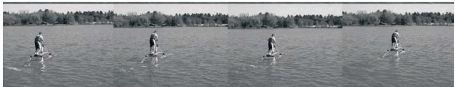
Además del empuje continuo que necesita el modelo para mantenerse a flote, es necesario además de un empuje inicial hacia adelante, como punto de partida y que hace entrar en funcionamiento los perfiles hidrodinámicos.
