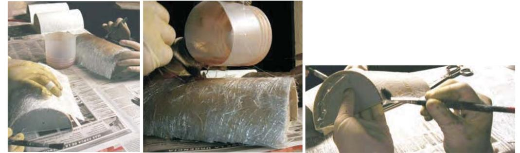
La pieza semicilíndrica vincula la pieza ajustable a los flotadores, y ubica las alas en un punto específico a lo largo de la nave. Por la curvatura interna se le adhiere velcro, para fijarla al flotador, evitando que se deslice y cambie la ubicación de las hidroalas con el empuje del agua.
