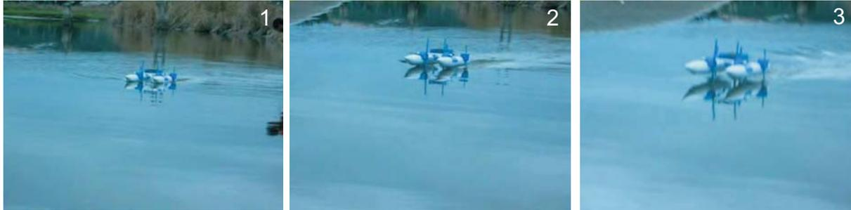
Como prueba final se ubican los perfiles alares mas cerca de los cascos, de manera que logra solucionarse el problema de estabilidad, y principalmente del roce que generara al estar en contacto con el agua, logrando mayor velocidad.
