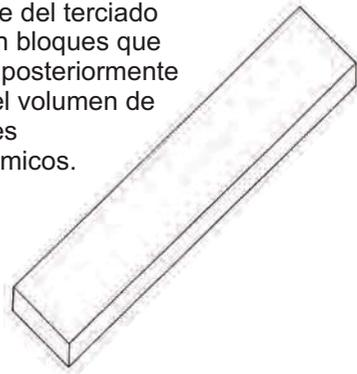
**2** Luego se marcan la forma de los perfiles alares en la parte lateral de los bloques de terciado.
