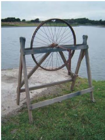
El sistema de remolque consiste en una rueda de bicicleta de 28 cm de radio montada sobre un caballete de madera, con una manivela para accionarla manualmente. El modelo es remolcado por un tensor enrollado en el perímetro de la rueda.
