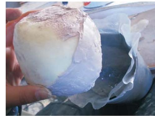
Una vez colocadas las piezas en los flotadores, se vuelve a aplicar masilla mágica en la unión de estas con los flotadores. Posteriormente, para un mejor sellado y pegado, se aplica una capa de sycaflex en la misma zona.
