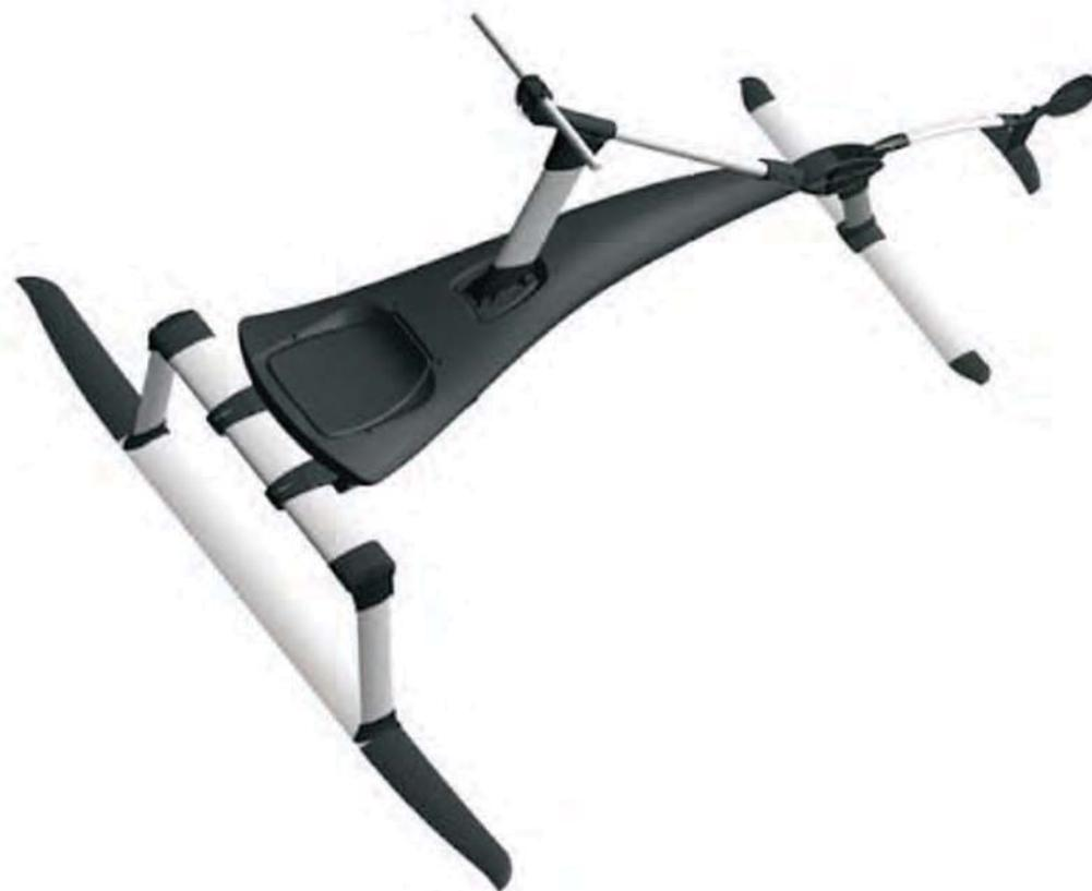
El desplazamiento necesita de un impulso inicial, para eso se necesita alguna plataforma en altura o una embarcación menor. Luego del primer impulso se realizan pequeños saltos en la plataforma que se ubica sobre el ala mayor. los saltos tienen que ser sincronizados, con un cierto ritmo para alcanzar el movimiento ondulatorio que permite el avance y la sustentación.
