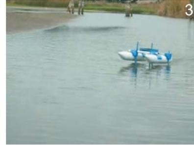
Una vez construido el modelo de pruebas fue necesario llevarlo a un lugar que tuviese condiciones similares a las que tendrá al ser construido a escala real. El propósito es lograr la mejor posición y combinación de las alas para que la velocidad y la sustentación sean óptimas. Para esto se eligió el estero de ritoque, ya que tiene la profundidad suficiente para los perfiles alares y las condiciones adecuadas para las pruebas.
