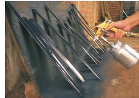
Previo al proceso de pintado, los perfiles se cubren con sellador, para evitar que la madera sufra por los efectos del agua en ellos.
