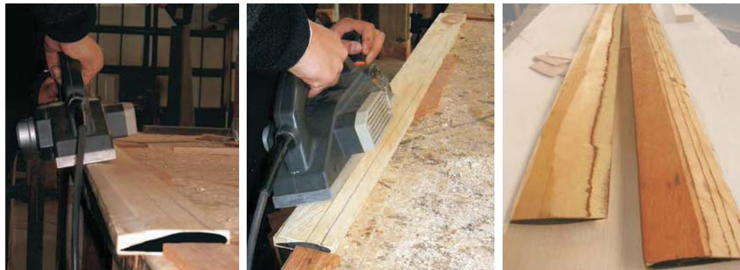
En el caso del perfil alar de doble curvatura, la curva de abajo fue necesario hacerla con una sierra,, puesto que se necesitaba lograr una curva homogénea y equivalente a lo largo de todo el perfil. Para esto se construyó una cuña, para fijar el perfil en una posición y se reguló la galleta, de modo que bajara cada vez la misma distancia, y no llegara a cortar el perfil completamente.
