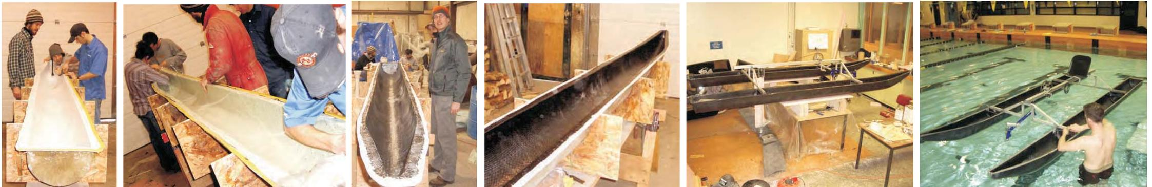
Los perfiles hidrodinámicos fueron diseñados por Philip Dennis y James Gregson. El primer paso implicó una profunda evaluación teórica y los cálculos relacionados con el caso específico del proyecto. Después de esto, se construyó un modelo de la escala, el cual sería probado en el tanque del remolque de Dalhousie.
