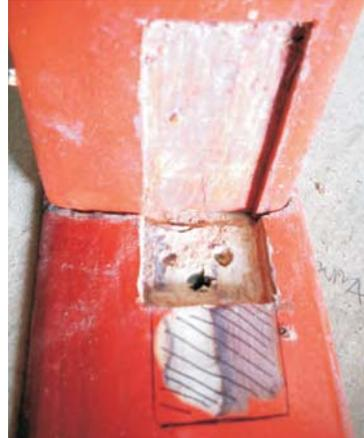
También se realiza una perforación en la superficie del perfil horizontal con la forma del perfil del ala vertical, permitiendo así un mejor montaje de ambas partes.
