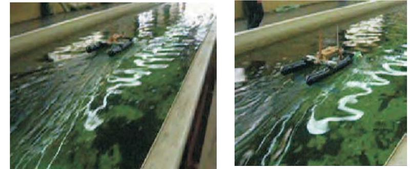
*Al elevarse el casco se elimina el roce se éste con el agua, actuando el flujo sobre una pequeña área que corresponde a los perfiles hidrodinámicos, lo que se ve reflejado en la diferencia que presentan las estelas en los dos momentos.*
