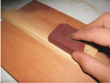
Cuando ya se tienen las dos láminas de madera puestas sobre el esqueleto se pasa a lijar el ala para eliminar las imperfecciones y ajustarse al perfil alar que se quiere. Tratando, en lo posible, de no debilitar mucho la madera ya que es parte importante de la estructuración del ala.
