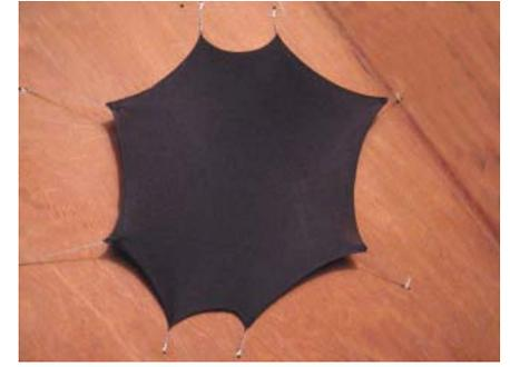
*CUBIERTA PARABOLOIDE HIPERBÓLICO 10 PUNTOS*
