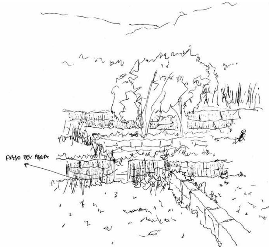
Internarse en el valle es adentrarse en el oír el agua, y la temperie o la sombra que se genera bajo un árbol con el agua en los pies. Esta agua es conducida mediante canales construidos en piedra volcánica con un ancho no superior a los 30 cms y de profundidad 60 cms, este tamaño es suficiente para aumentar el caudal de agua y generar mediante el cambio de la pendiente del lugar y recorrido que en ocasiones rompe lo rectilíneo el golpe del agua y su sonido.
