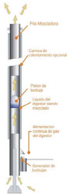
Figura 5.3. Esquema de mezclado con tecnología Cannon Mixer
