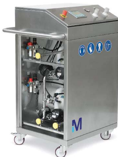
Figura 5.7: Skid cromatográfico de cromatografía de exclusión molecular.
