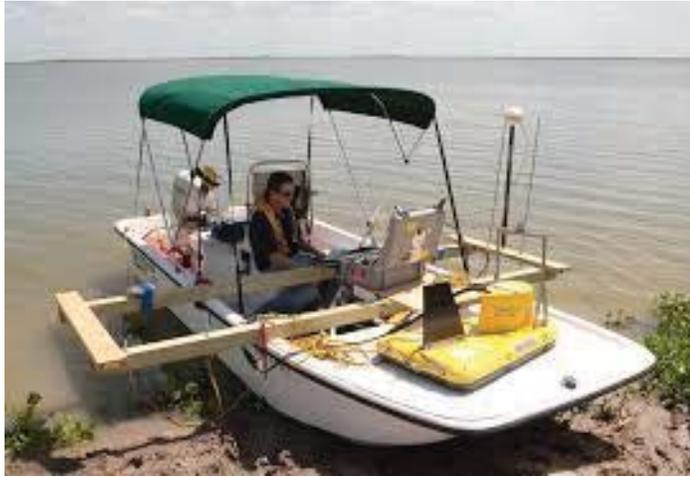
**Figura 30.**Montaje en bote de fibra de vidrio del SBP 3200 HP de EdgeTech.
